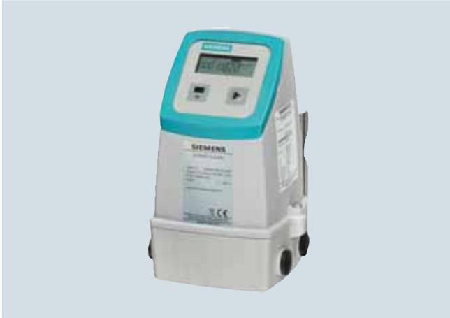
Измерительный преобразователь на базе времени прохождения сигнала SITRANS FUS080 разработан для ультразвукового измерения расхода вместе с любыми встраиваемыми в линию датчиками серии FUS: SONOKIT, FUS380 и FUE380 диаметром до DN 1200.
