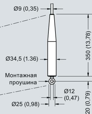
SITRANS LC300 — фланцевые подключения к процессу, габариты в мм
