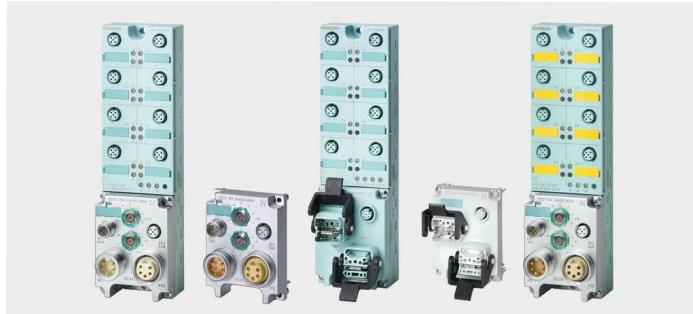
Станции ET 200eco выполняют функции стандартных ведомых устройств сети PROFIBUS DP и способны поддерживать обмен данными с ведущим DP устройством со скоростью до 12 Мбит/с. Каждая станция ET 200eco состоит из базового модуля и соединительного блока.
