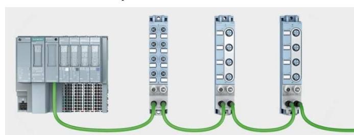
Все модули станции ET 200AL выпускаются в компактных пластиковых корпусах размерами 45x159x34 мм для интерфейсных модулей и 30x159x34 мм для всех остальных модулей. Эти модули могут монтироваться на плоские поверхности или на алюминиевые профили в любых рабочих положениях.
