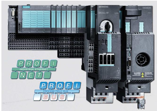
Станции ET200S используются для построения систем распределенного ввода-вывода программируемых контроллеров SIMATIC S7-300/ S7-400/ WinAC, базирующихся на промышленных сетях PROFIBUS DP или PROFINET IO.
