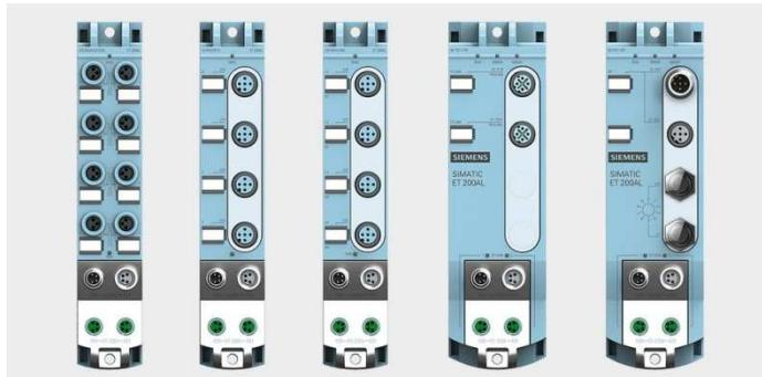
Станция ET 200AL имеет модульную конструкцию, компактные размеры, степень защиты IP65/IP67 и диапазон рабочих температур от -25 до +55 °C. Ее модули могут устанавливаться в ограниченных монтажных объемах непосредственно на производственных машинах вне шкафов управления на расстояниях до 10 м друг от друга. Допускается установка модулей на подвижные части производственных машин.
