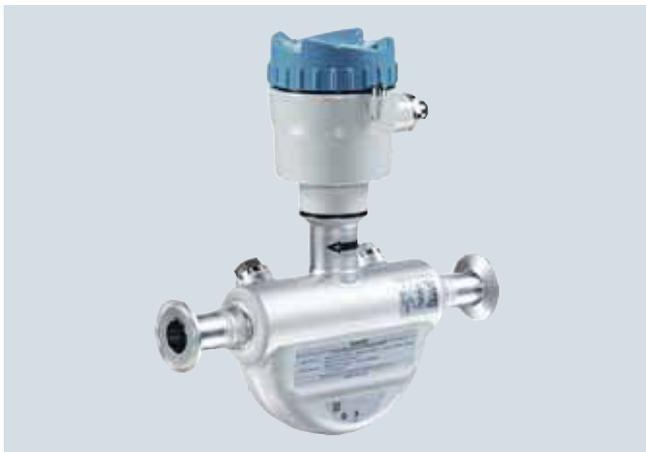
Принцип измерения расхода основывается на законе Кориолиса. Расходомер SITRANS FC430 состоит из датчика типа FCS400 и измерительного преобразователя FCT030. Измерительные трубки датчика FCS400 возбуждаются электрической цепью электромагнитного привода, который создает в них колебания, соответствующие их резонансной частоте.
